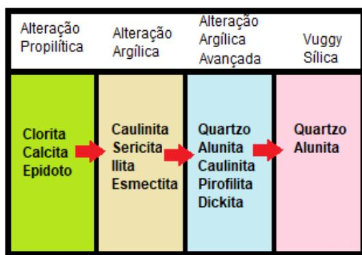
**Figura 17:** Esquema de alterações, indicando os minerais mais comuns em cada fase de alteração.
